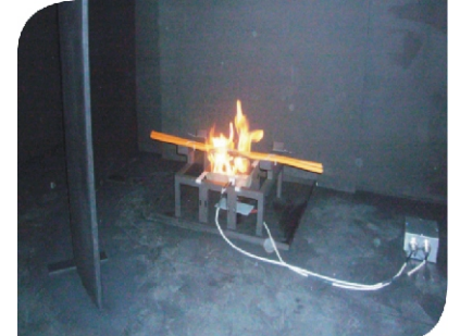
Một số hình ảnh tại phòng thử nghiệm Cáp chống cháy tại LiOA Electric/ Our fine test Fire resistance cable in LiOA Electric
