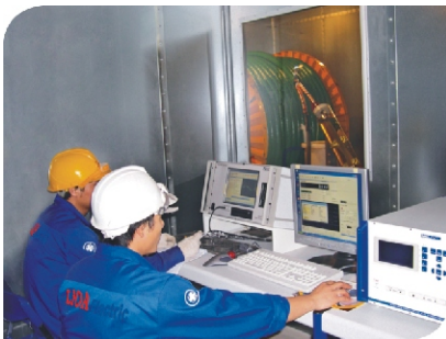
Một số hình ảnh tại phòng thử nghiệm Cáp chống cháy tại LiOA Electric/ Our fine test Fire resistance cable in LiOA Electric
